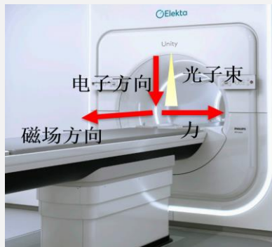
图2.2 磁场对带电粒子的洛伦兹力作用示意图
